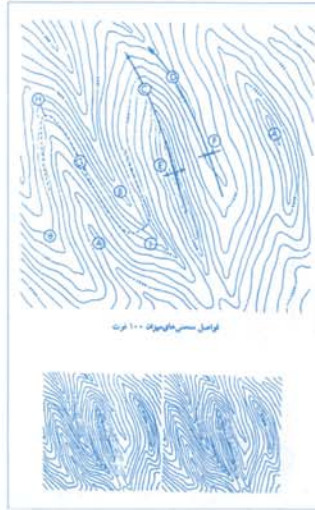
نگاره (۲): نقشه توپوگرافی (الف) و نقشه استریوسکوپ (ب) از یک چشم‌انداز چین‌خورده (تاق‌دیس و ناودیس)
